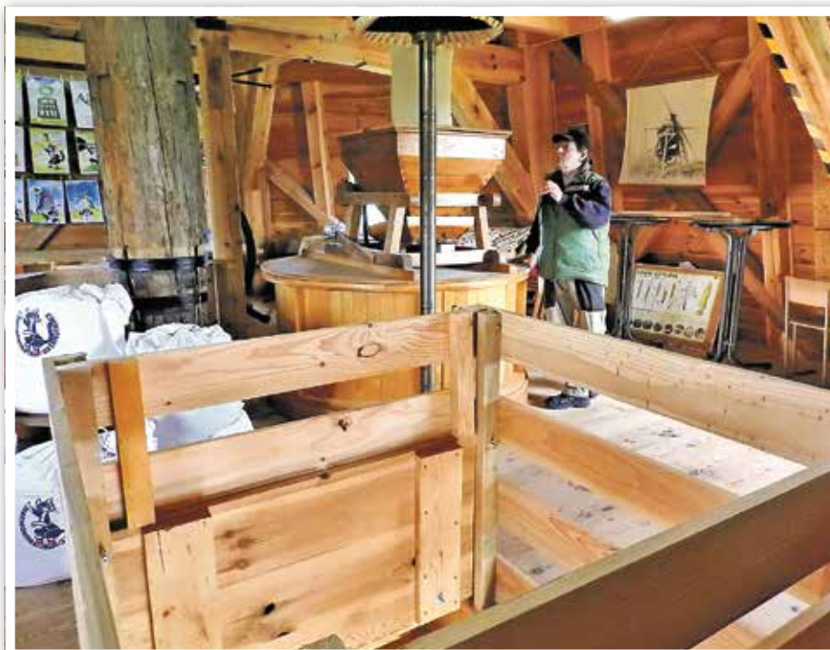
Das Mahlgut wird in den Trichter geschüttet.
