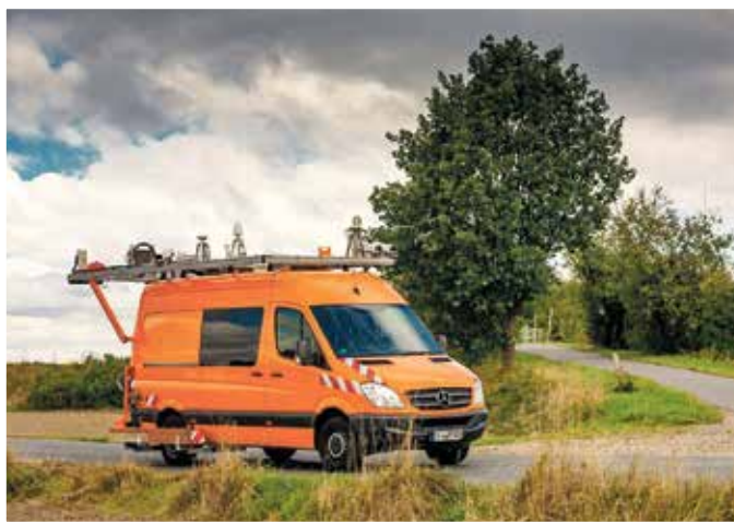
Messfahrzeug für Messung Ebenheit und Substanzmerkmale
