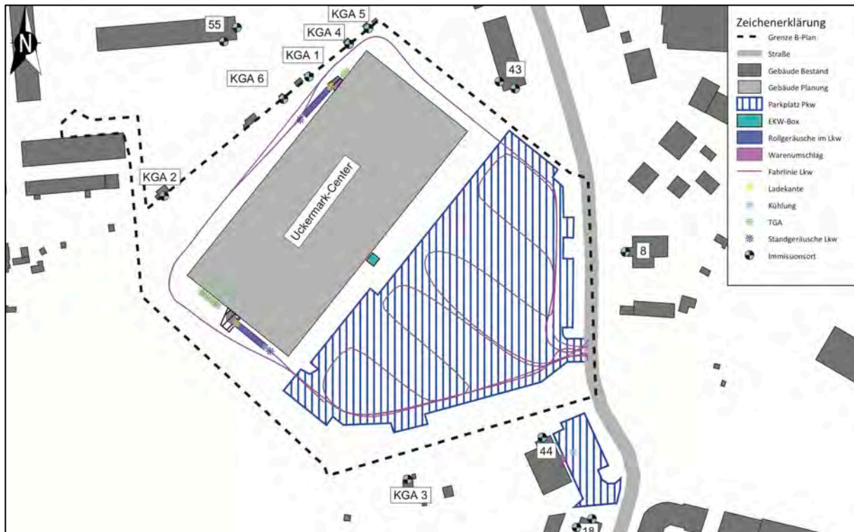
Abbildung 4-1: Übersicht der Anlagenschallquellen
